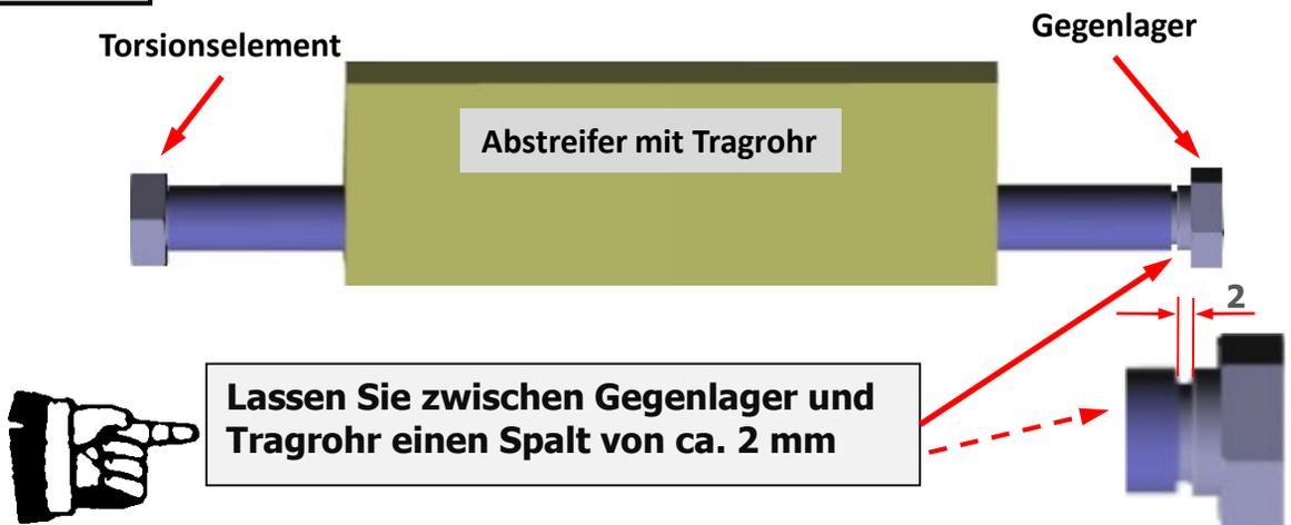
Ermitteln Sie nun das Rohmaß **L**. Dazu messen Sie den Abstreifer einschließlich des eingesteckten Gegenlagers und dem Torsionselement (*Bild 8*).
